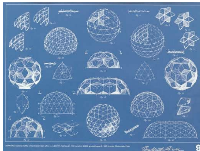
Fig.3 Desenhos do registro de patente da cúpula geodésica de Fuller (Fonte: google)
